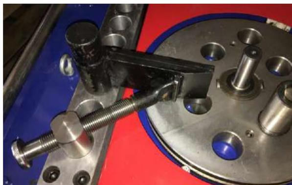
Запускаем станок и осуществляем гибку.
