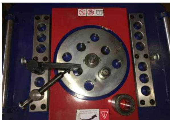
Осуществляем пробный запуск в автоматическом режиме, проверяем правильность выбранного угла. Устанавливаем упор как изображено на фотографии. Вылет уголка регулируется ручкой вращения. Проводим прут арматуры вдоль упора и фиксируем его согласно диаметру стержня.
