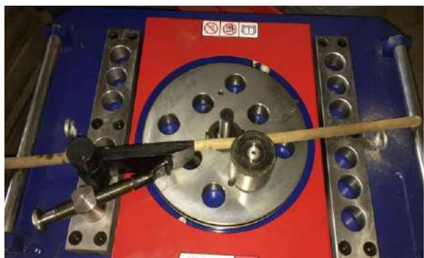
После окончания работы отключаем питание на станке. Убираем все гибочные приспособления с рабочего стола. Очищаем рабочую поверхность от окалины и все посадочные отверстия под гибочные приспособления смазываем маслом.
