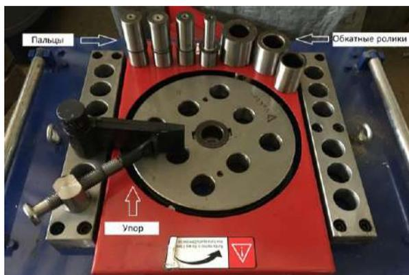
Для осуществления гибки необходимо вставить гибочные пальцы в отверстие на планшайбе. Устанавливаем центральный периферийный палец вместе с обкатным роликом на рабочий поворотный диск.
